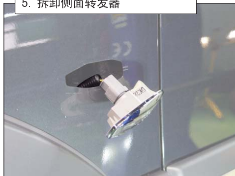
5. 拆卸侧面转发器
